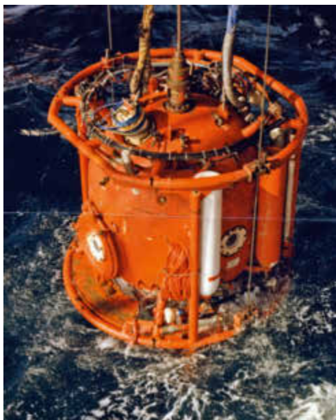
Dykkerklokka heises ned i forbindelse med arbeid på Frigg-feltet i 1976 eller 1977. Foto: Norsk Oljemuseum.
